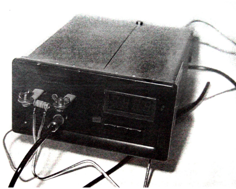
Fig.12.7. Fotografia micro-ohmetrului digital cu proba din aliaj cu memorie montată împreună cu rezistența de încălzire.
