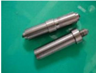
Fig. fsw.4. Scule pentru sudarea prin frecare cu amestecare: partea activă și ansamblul.
