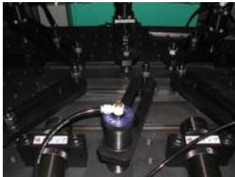
Fig. fsw.5. Fixarea pieselor de îmbinat pe masa mașinii de lucru.
