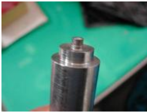
Fig. fsw.4. Scule pentru sudarea prin frecare cu amestecare: partea activă și ansamblul.
