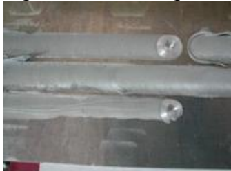
Fig. fsw.6. Aspectul unor cusături sudate pe aliaje de aluminiu. Capătul sudurii.
