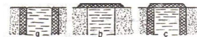
Fig.2.57.Soluții pentru izolarea unor maselote directe, deschise
