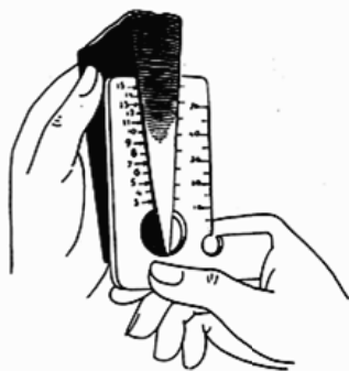
Figura 13.1. Proba pană și rigla gradată specială de măsurare a lungimii zonei albe din ruptura probei pană.
