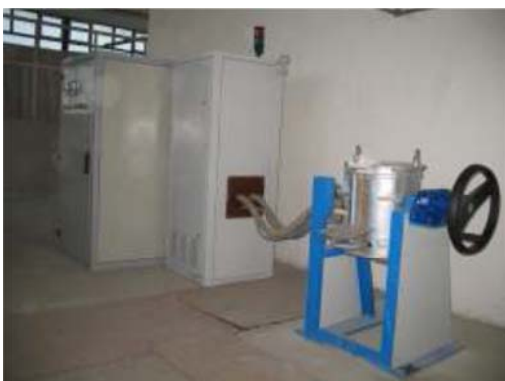
Fig.4. Cuptorul electric cu încălzire prin inducție utilizat pentru realizarea lucrării de laborator.
