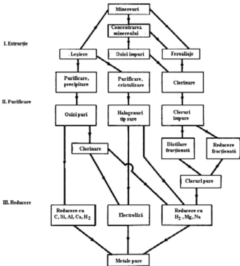
Figura 14.5. Căi alternative pentru producerea de metale pure [6].
