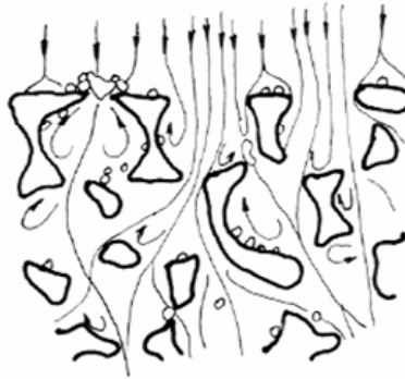
Fig. 3.2. Schema de principiu a filtrării interioare
