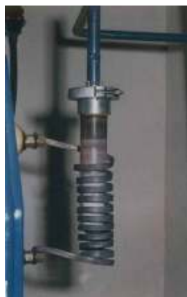
Figura 5. Inductor cu incintă din cuarț vidată
