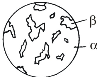
Fig. 2. Schema microstructurii aliajului Al-Mg turnat, cu 10% Mg.
