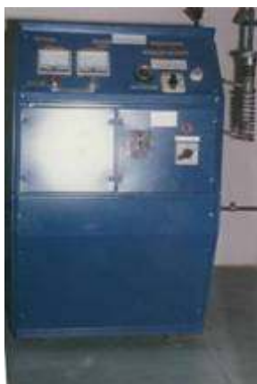
Figura 4. Generator de înaltă frecvență de 2,6MHz și 5KW
