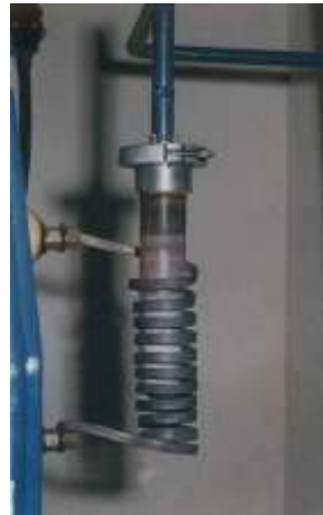
Figura 7. Inductor cu incintă din cuarț vidată
