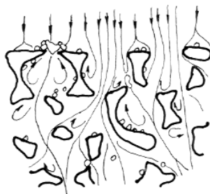
Figura 1. Schema de principiu a filtrării interioare.
