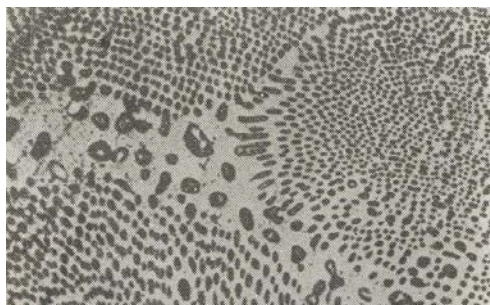
Fig. 3.6. Microstructura în baghete a eutecticului Sn-Cd cu 67,8%Sn + 32,2%Cd și temperatura de topire 180 °C[14].
