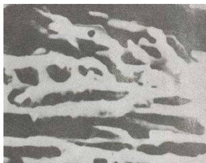
Fig. 3.8. Microstructura eutecticului \alpha + \text{Si} din aliajul Al-Si la 11,7% Si în reprezentare spațială x 6000[14].
