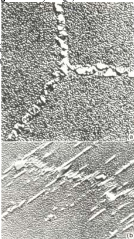
Fig.2.1 Efectele modului de precipitare al carburilor asupra proprietăților unui superaliaj Waspaloy: (a) efect favorabil prin precipitarea de-a lungul limitelor de grăunți; (b) efect nefavorabil prin precipitarea discontinuă de tip „fermoar”
