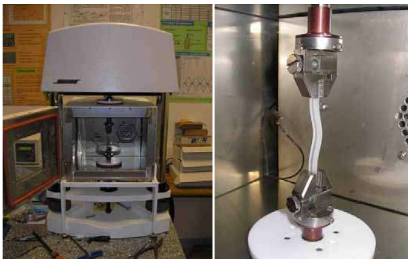
Fig.4.31 Detalii ale experimentelor mecano-dinamice: (a) vedere de ansamblu; (b) detaliu de fixare a probei (Klesa, 2009)
