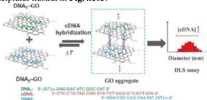
Fig.4.103 Proceduri de auto-asamblare a oxidului de grafenă direcționat de ADN și de analiză a împrăștierii dinamice a luminii dynamic light scattering (DLS)
