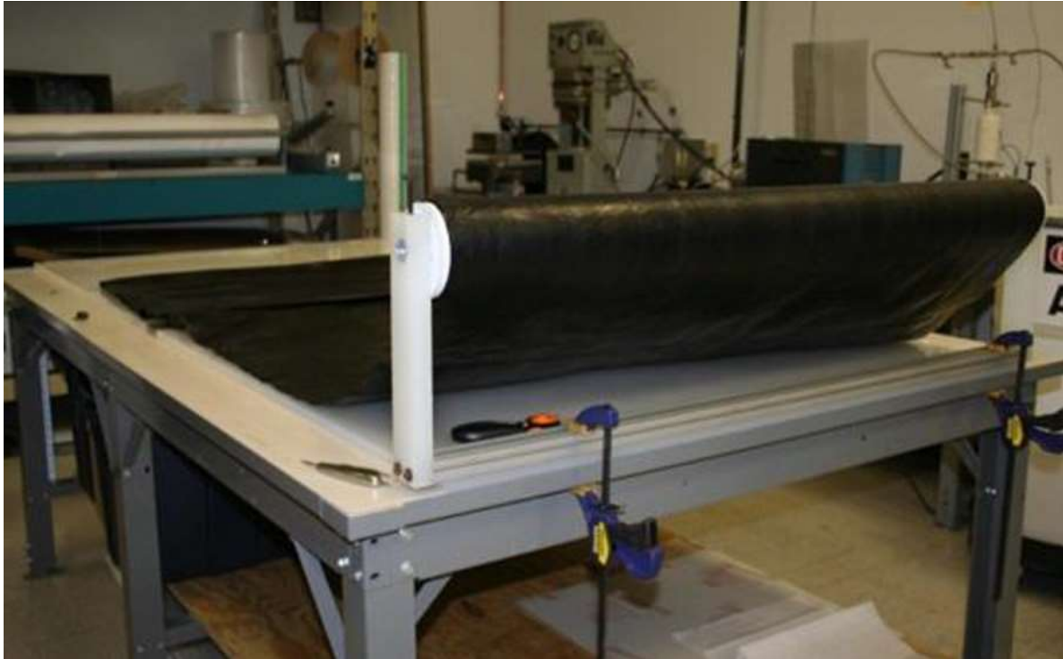
Fig.4.97 Rolă lungă cu folie de nanotuburi, lată de, 1.2 m, cu o densitate de 15 g/cm 2 .
