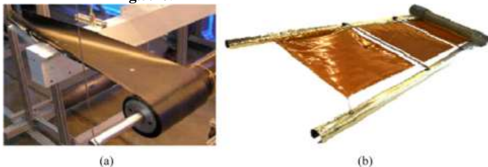
Fig.5.40 Model de desfășurare a învelișului EMC: (a) înveliș și (b) model parțial desfășurat al sistemelor solare susținute de învelișul EMC (Liu, 2014)
