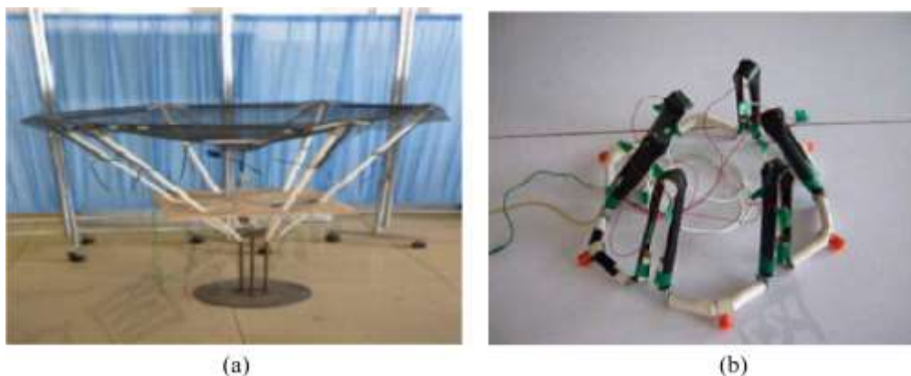
Fig.5.41 Modelul de antenă cu suprafața în fâșii desfășurabilă în spațiu: (a) antena CPMF desfășurată și (b) învelișuri subțiri CPMF împachetate (Liu, 2014)
