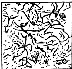
Fig. 10.12. Grafit lamelar grosolan.
