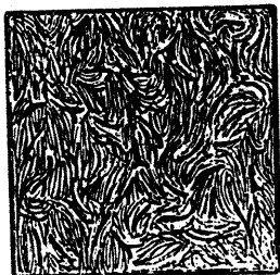
Fig.10.19. Fontă perlitică modificată cu grafit fin.
