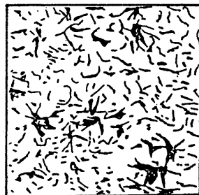
Fig. 10.13. Grafit lamelar fin.
