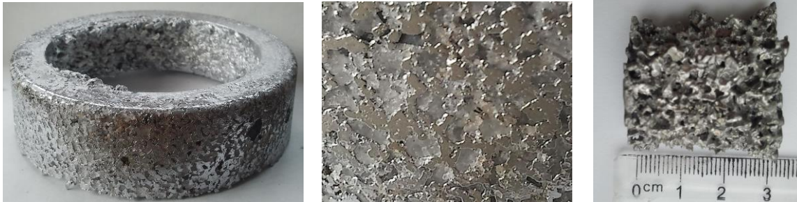
Fig. 3. a) Piesa turnata centrifugal; b) detaliu pe suprafata exterioară după turnare; c) detaliu pe suprafata interioară a piesei după dizolvarea clorurii de sodiu.
