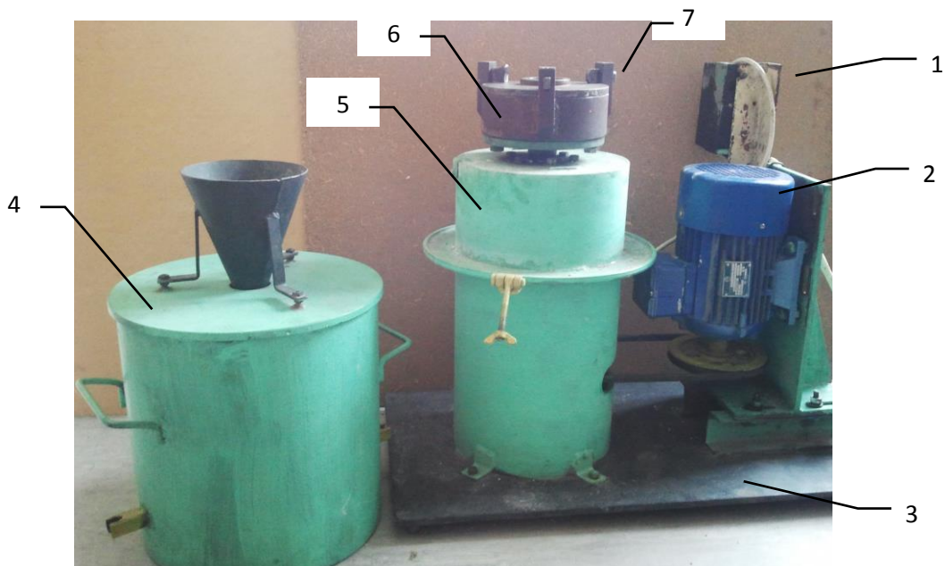
Fig. 2. Instalație de turnare centrifugă, cu axă verticală de rotație și turație constantă: 1 – butoane de comandă; 2 – electromotor de curent alternativ, trifazat; 3 – placă de bază; 4 –
