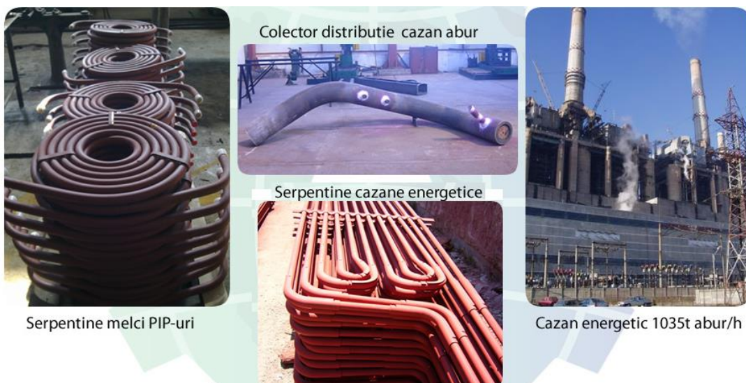
Figura 1. Elemente componente ale unui cazan energetic
