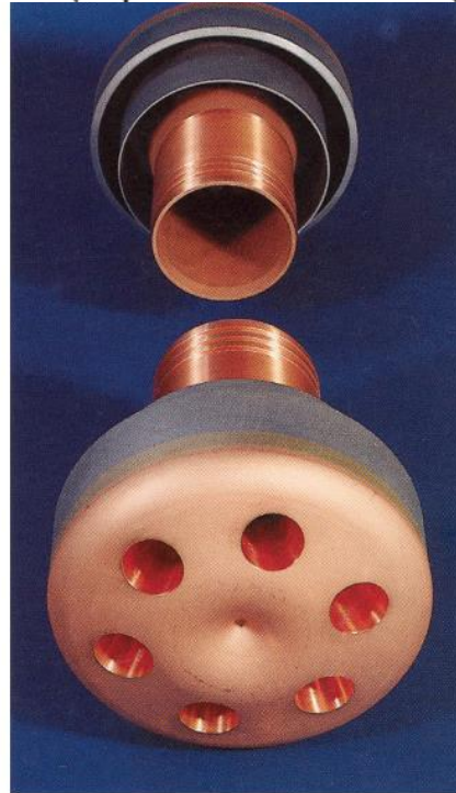
Fig. 3.27. Cap de lance cu șase duze pentru suflarea oxigenului, confecționat din cupru.
