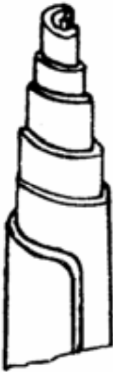
Figura 1.10 Formarea filamentului monocristalin de grafit
