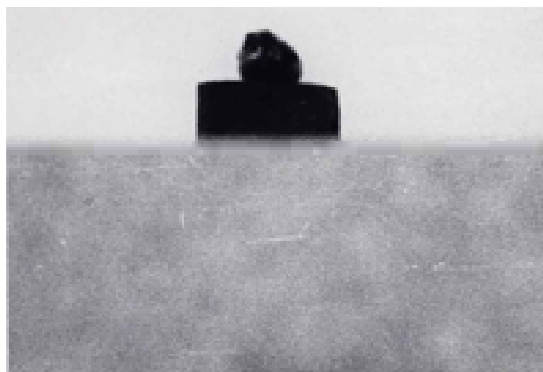
Figura 5.22. Picătura de Al pe suport de grafit
