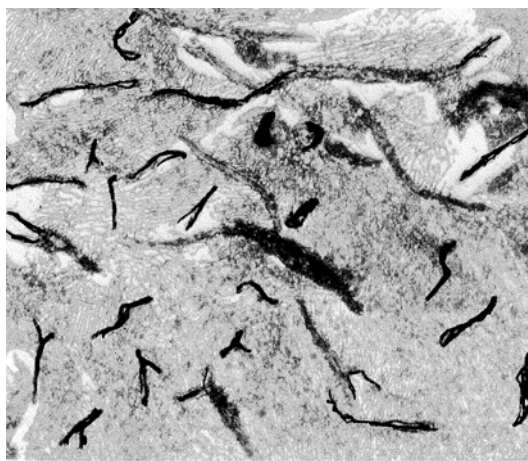
Fig. 4.25. Fontă cenușie perlitică pentru roți dințate
