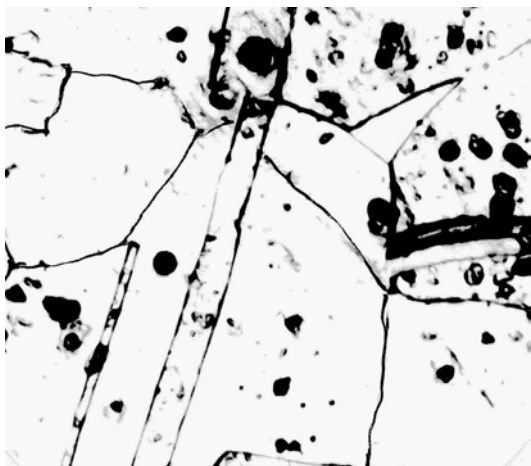
Fig.6.33. Structura magneziului recopt
