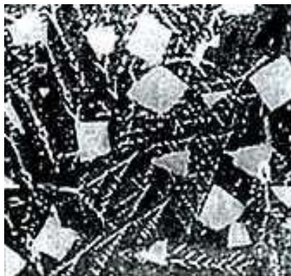
Fig. 6.5. Aliaj antifricțiune Y Sn 83. Compuși chimici poligonali și aciculari.
