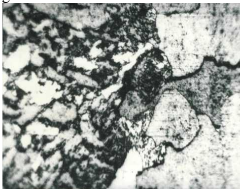
Fig. 11.8. Oțel OL37 (S 235 YR) sudat. Zonă de supraîncălzire vecină cu zonă de normalizare.
