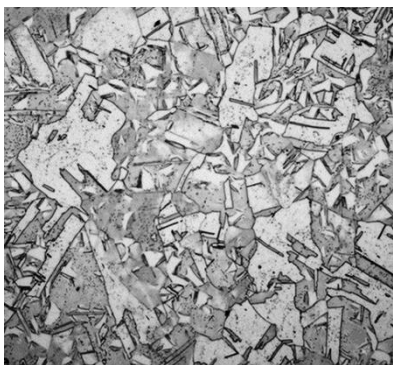
Fig. 11.3.a. Cupru deformat plastic la rece și recristalizat incomplet.
