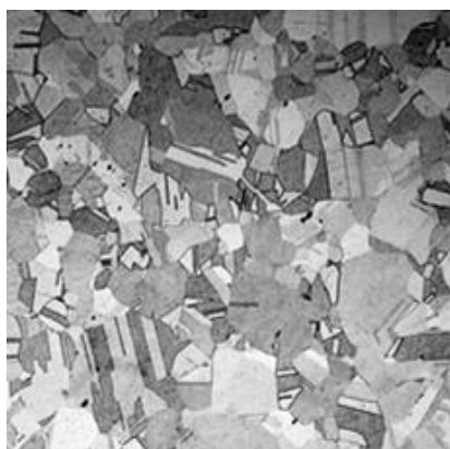
Fig. 6.3. Aliaj Cu-Zn – Alamă deformată la rece. Grăunți poliedrici..
