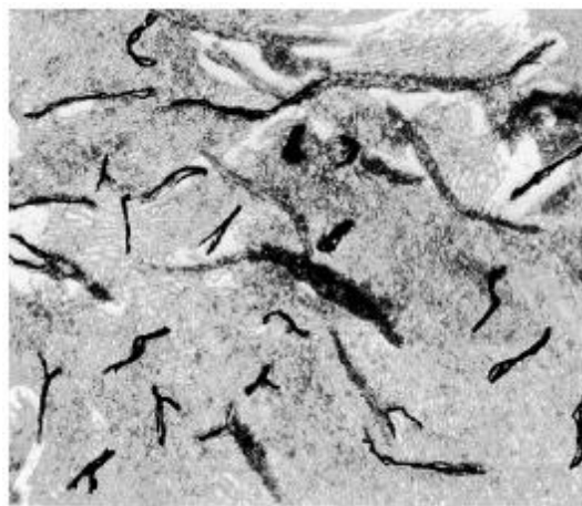
Fig.10.1. Fontă cenușie perlitică pentru roți dințate
